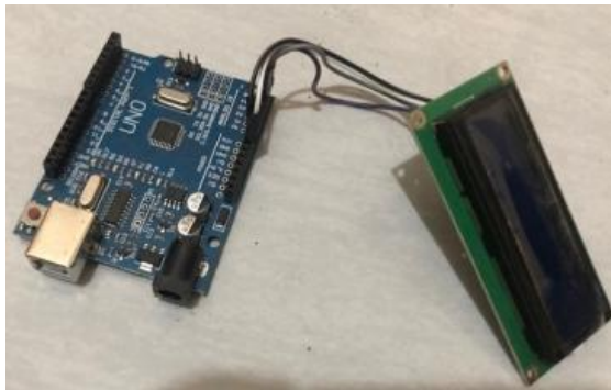
Gambar 2. Rangkaian LCD ke Mikrokontroler
