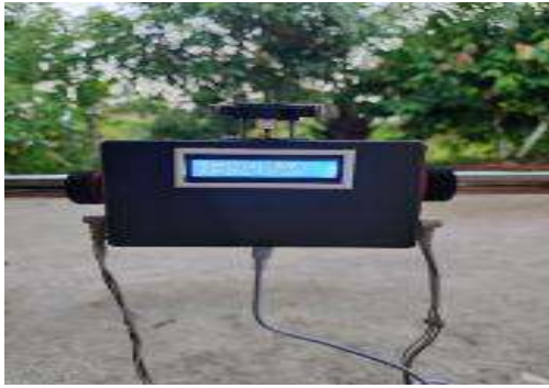
Gambar 8. Konstruksi Perangkat Keras Alat Perhitungan Chinning up dan Pull Up
